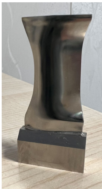
图 16 经过加工的叶片 Fig.16 Machined blade
